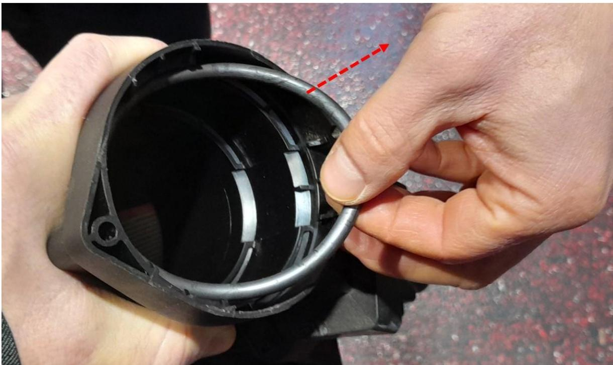
10. Dichtgummi auf Luftmassenmesser schieben und mit etwas Montagefett oder Silikonspray benetzen
