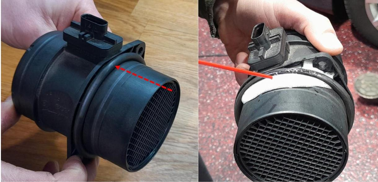
11. Luftmassenmesser mit Dichtgummi an RevDop Intake montieren
