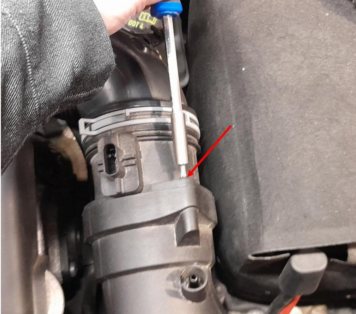
6. Schlauchschelle mit Schellenzange am Luftmassenmesser lösen und abziehen
