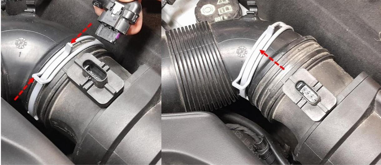
7. Originalen Luftfilterkasten nach oben herausziehen
