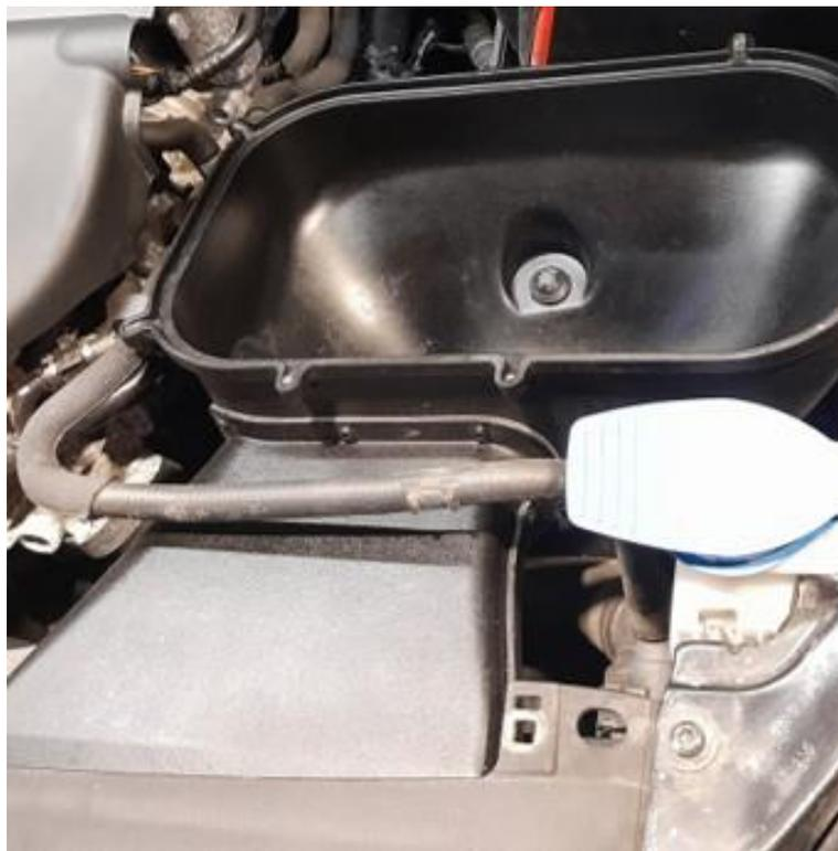
4. Neues oder gereinigtes Filterelement einsetzen und Oberkasten mit Unterkasten verschrauben
