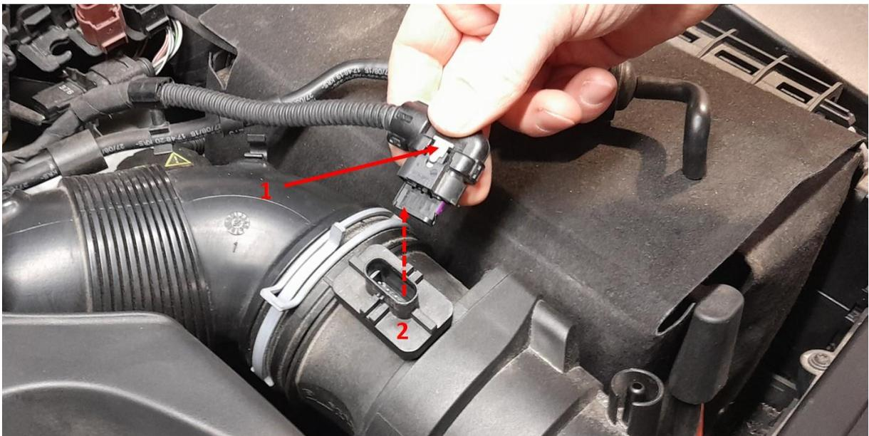
5. Schraube vom Luftmassenmesser entfernen
